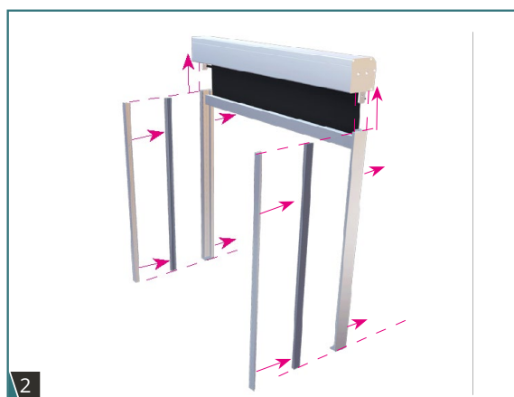
Rys. 2. Sprawdzić czy system jest kompletny i zgodny z zamówieniem. Zmierzyć kasetę i prowadnice.
