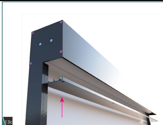
Rys. 13c. Zastosowanie montażu w przypadku: Zipner 110 slim . Nałożyć i przykręcić część rewizyjną kasety.
