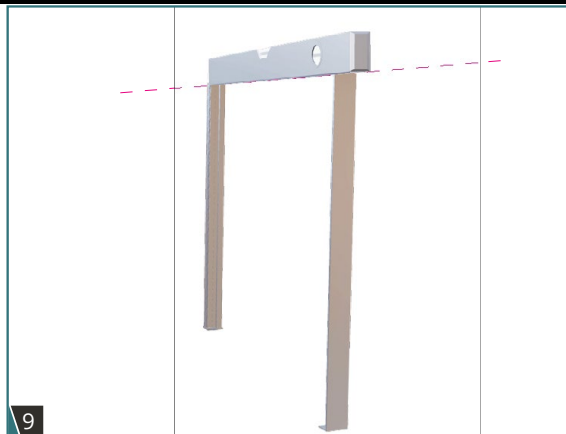
Rys. 9. Upewnić się, że prowadnice znajdują się na takim samym poziomie.
