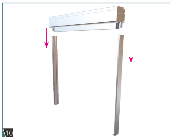
Rys. 10. Nałożyć kasetę na prowadnice. Prawidłowy montaż uchwytów prowadnicy i kasety: co 70 cm.
