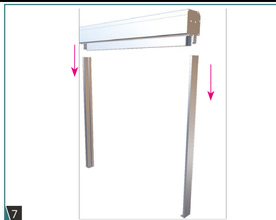
Rys. 7. Nałożyć kasetę na prowadnice.
